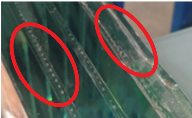
SentryGlas-Kante vor (rechts) und nach (links) Bearbeitung.
